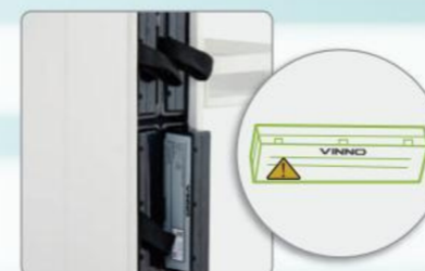
Bateria de reserva
